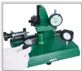
Test de fuerza para los relojes analógicos
