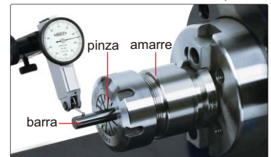
medición radial del centrado de la pinza
