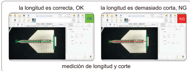
medición herramientas corte
