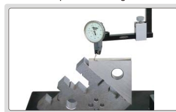
inspección del ángulo
