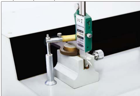
se pueden pulir las patas de medición de los calibres
