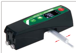
punta de contacto con giro a 90° para medición transversal
